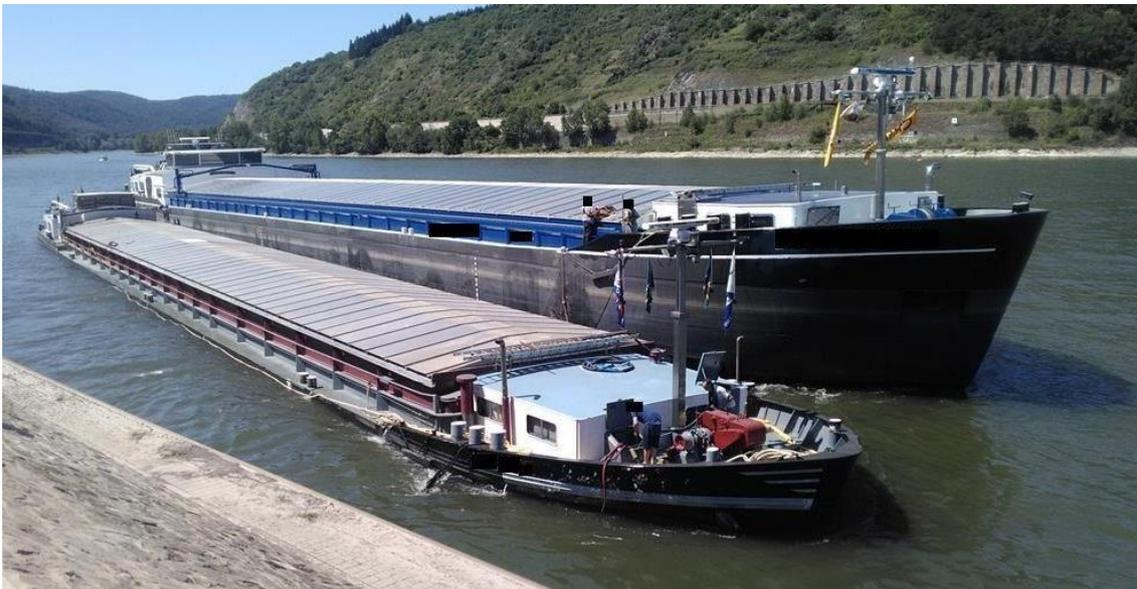
Abbildung 6 - Motorgüterschiff beladen/unbeladen | © ViaDonau
