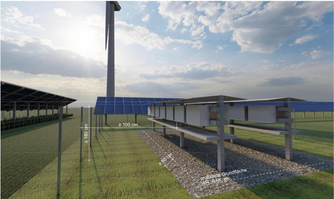
**Abbildung 3 – Zugriffschutz von Kabelanlagen und Steckverbindungen**
