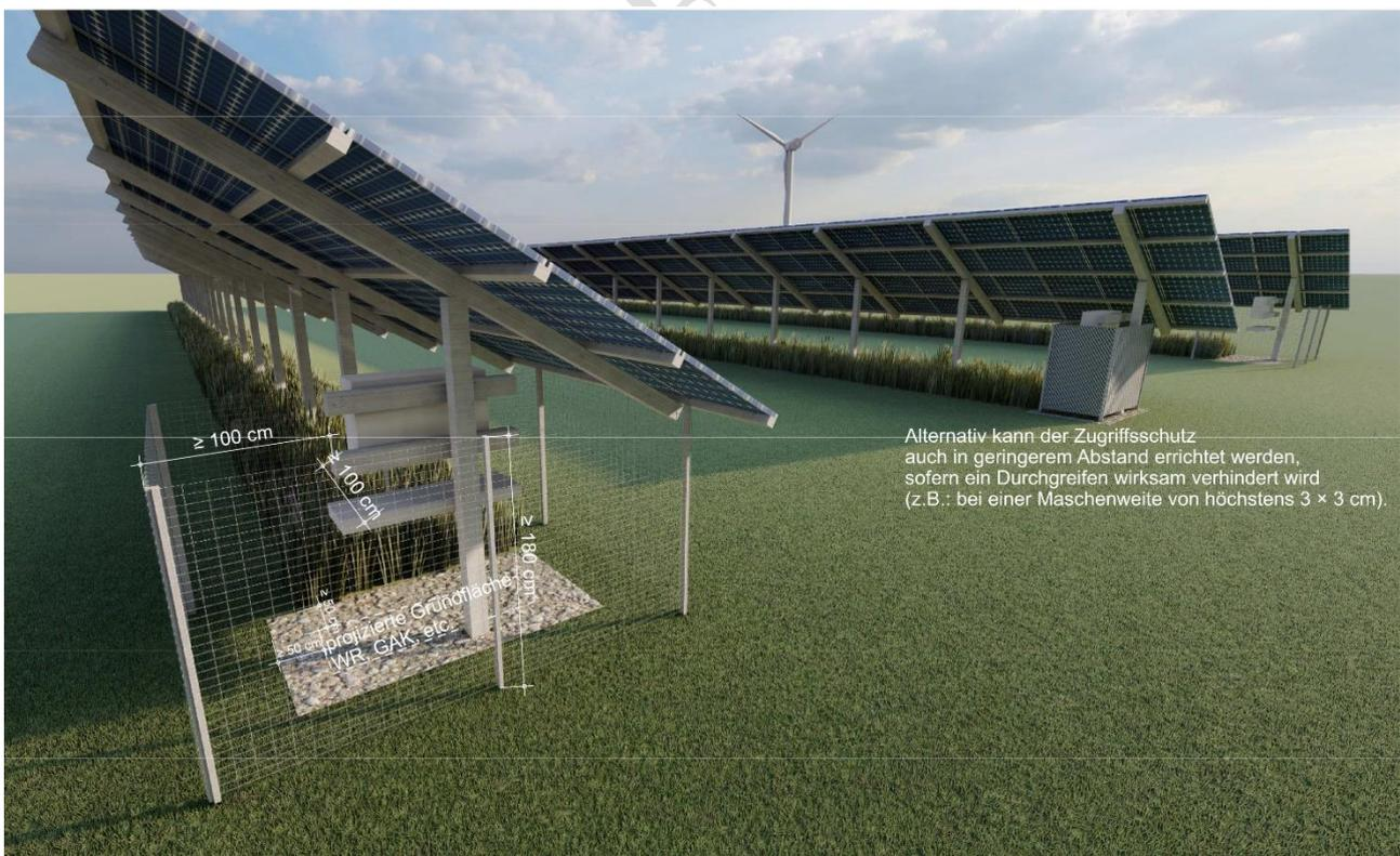
Abbildung 2 – Zugriffsschutz von Kabelanlagen und Steckverbindungen
