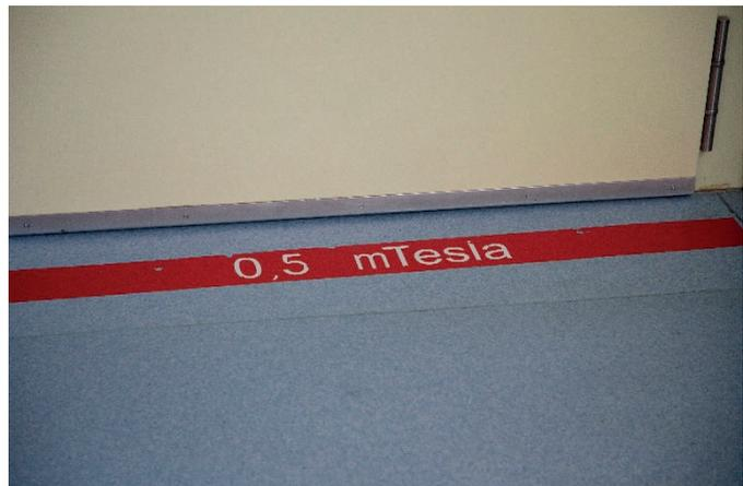
Abbildung 4 und 5: Kennzeichnung des Bereichs mit 0,5 mTesla
