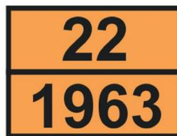
Abbildung 19: UN-Kennzeichnung für Helium, tiefgekühlt, flüssig
