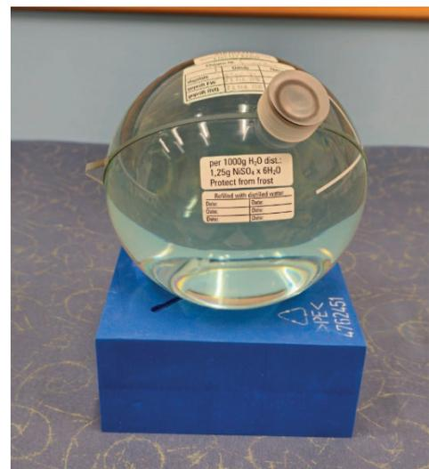
Abbildung 24: Messphantom
