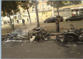
Beim Brand eines alternativ angetriebenen Fahrzeuges während des Ladevorgangs bleibt der Einsatzvorgang gleich. Es ist allerdings ratsam, das Fahrzeug vom Netz zu trennen (Energiezufuhr unterbrechen: LPG, CNG, Wasserstoff, Strom).
