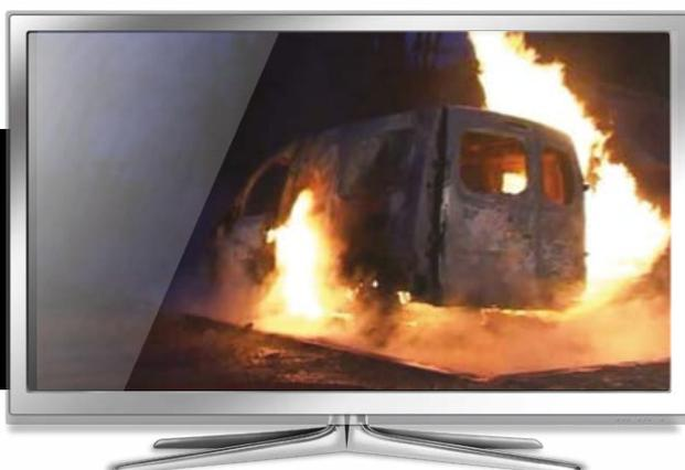
Die Überhitzung der Batterie setzt brennbares Gas frei. Die Flammen eines Hybrid- oder Elektrofahrzeugbrandes ähneln daher Gasflammen.
