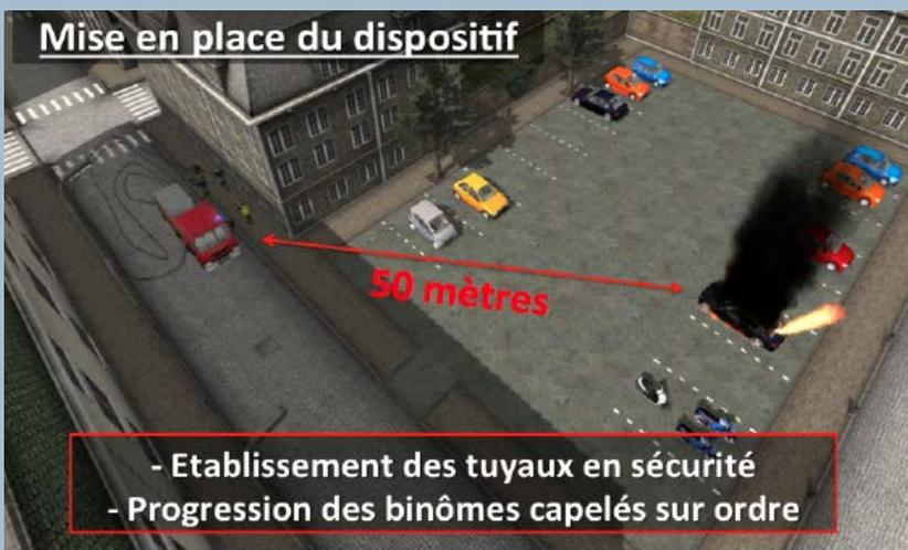
Um die Einsatzkräfte vor einer Gasexplosion (BLEVE) zu schützen, sollte die Schlauchleitung so gelegt werden, dass verfügbare Strukturen als Schutzwall genutzt werden können (Mauern, Fahrzeuge).
