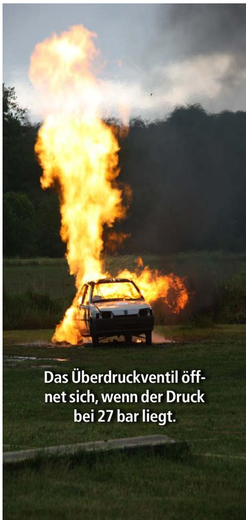
Das Überdruckventil öffnet sich, wenn der Druck bei 27 bar liegt.
