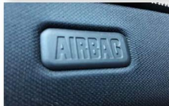
Die ungefähre Position eines Airbags im Fahrzeug kann je nach Modell durch die folgenden Kennzeichnungen ermittelt werden: **SRS AIRBAG, AIRBAG, SRP, SIPS BAG, SIR, HPS, IC, WC, RS...** oder durch ein Symbol auf dem Armaturenbrett oder auf der Windschutzscheibe.
