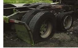
Im Falle eines Fahrzeugbrandes (insbesondere bei LKWs und Bussen) kann das Platzen eines Reifens daher für die Einsatzkräfte gefährlich sein (Knall, umherfliegende Teile, Hörsturz). Vorsicht vor verzögerten Reifenplatzen, die nach dem vollständigen Ablöschen des Fahrzeugs auftreten können!
