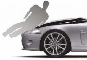
2 Les capteurs envoient un signal qui provoque le soulèvement du capot.
