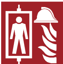
Abbildung 6: Piktogramm Feuerwehraufzug gem. EN 81-72
