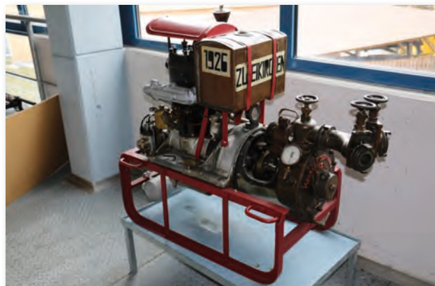
Abb. 1 Tragkraftspritze IIa, Baujahr 1926, Erzeuger Firma Rosenbauer, 500 l/50 FH, FF Zweikirchen)
