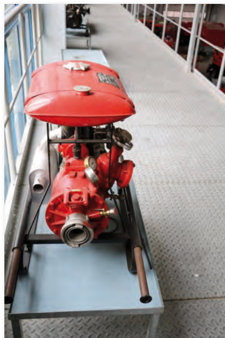
Abb. 4 Tragkraftspritze TS 8 R, Baujahr 1946, Erzeuger Firma Rosenbauer, 800 l/80 FH, Kärntner Landesfeuerwehrverband)
