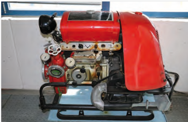
Abb. 5 Tragkraftspritze Automatic 75 VW, Baujahr 1964, Erzeuger Firma Rosenbauer, 750 lt/100 FH, FF Villach
