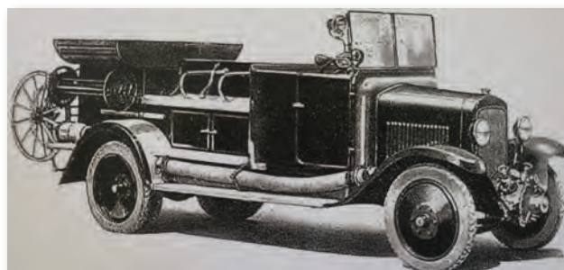
Abb. 4 Überlandautospritze aus dem Jahr 1931, vorne eingebaute Pumpe, außenliegende Längssitze für 8 Mann
