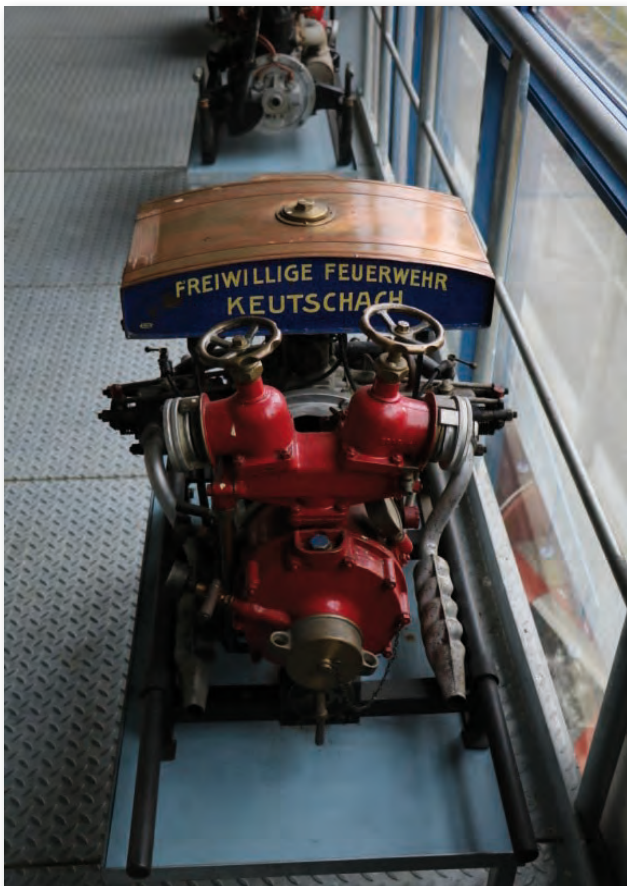
Abb. 2 Tragkraftspritze B 48, Baujahr 1929, Erzeuger Firma Rosenbauer, 600 l/80 FH, FF Keutschach)
