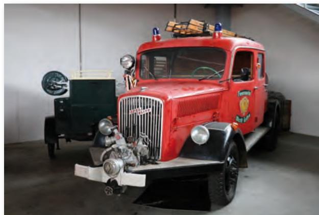
Abb. 6 TLF 2000 mit Vorbaupumpe, Fahrgestell Opel Blitz 3,6t, Fahrgestell 1942, Pumpe und Aufbau 1957, FF Markt Griffen
