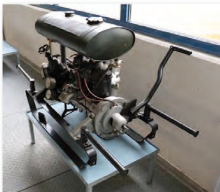
Abb. 3 Tragkraftspritze R 80, Baujahr 1943, Erzeuger Firma Rosenbauer, 800 l/80 FH, Zweitaktmotor, FF Obervellach)
