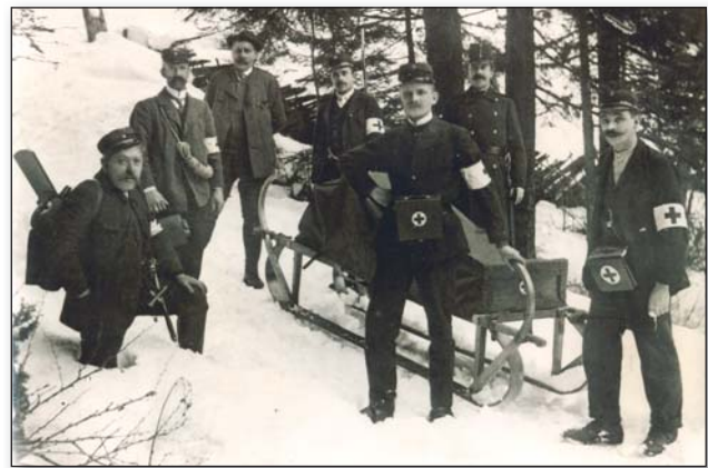
Abb. 5. Zerlegbarer Rettungsschlitten zum Krankentransport im Winter aus höher gelegenen unwegsamen Berggegenden.
