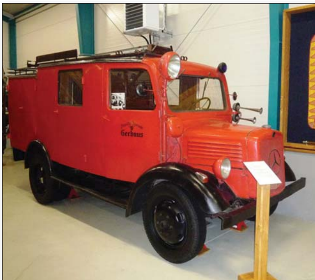
Abb. 6. Dieses Löschfahrzeug 8 stand 1943 bis 1957 bei der FF Bruck an der Leitha in Verwendung (vorübergehend sogar als Sanitätswagen). Es wurde anschließend an die Feuerwehr Gerhaus verkauft. Baujahr: 1942, Fahrgestell: Mercedes Benz L1500 S; Aufbau: vermutlich Magirus, Ulm (Archiv FF Bruck).
