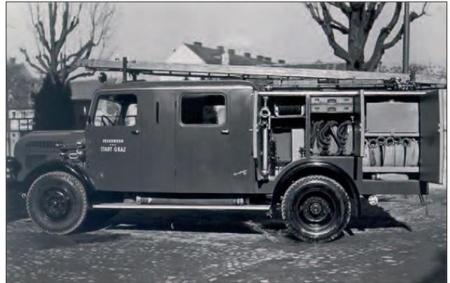
Abb. 10. Tanklöschfahrzeug, Modell Graz, Takt. Zeichen: TLF 1000, Type: Steyr Diesel 380, Pumpe: 4stufige Kreiselpumpe, 250 l/min bei 40 bar, 800 l/min bei 8 bar, 1500 Liter Wasser, 100 Liter Schaum.
