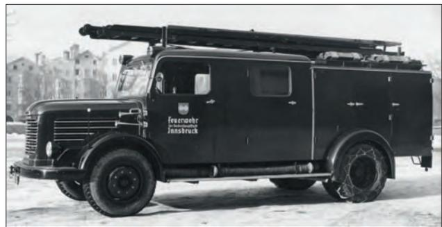
Abb. 13. TLFH-1500 Steyr 380 mit Hochdruckpumpe, Baujahr 1954
