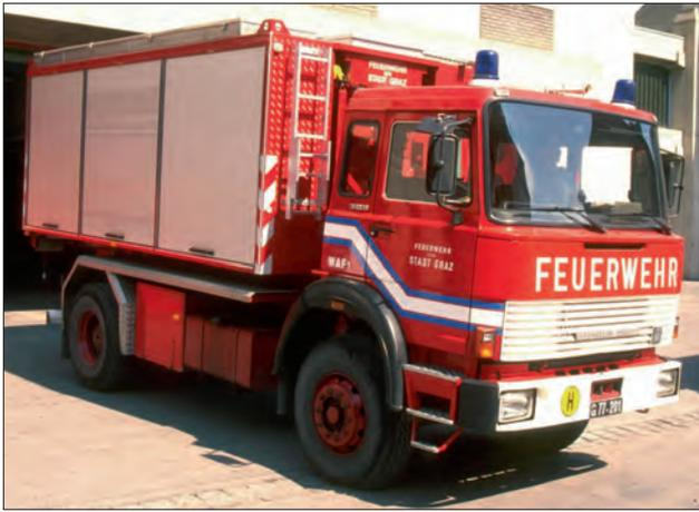
Abb. 15. Wechselaufbaufahrzeug, Takt. Zeichen WAF 1, Magirus Deutz 256 M19, Baujahr 1981, Gesamtgewicht 16 t, Motor 8 Zylinder Diesel, 188 kW.
