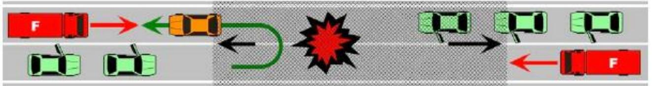
Bild 15: Phase Fremdrettung und Löscheinsatz im einröhrigen Tunnel mit Gegenverkehr [1]
