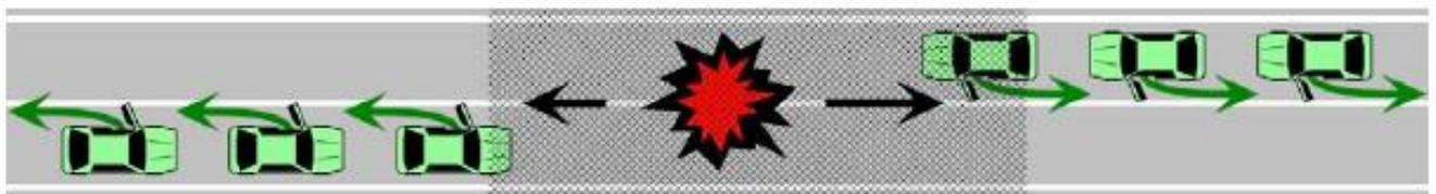
Bild 14: Phase Selbstrettung im einröhrigen Tunnel mit Gegenverkehr [1]
